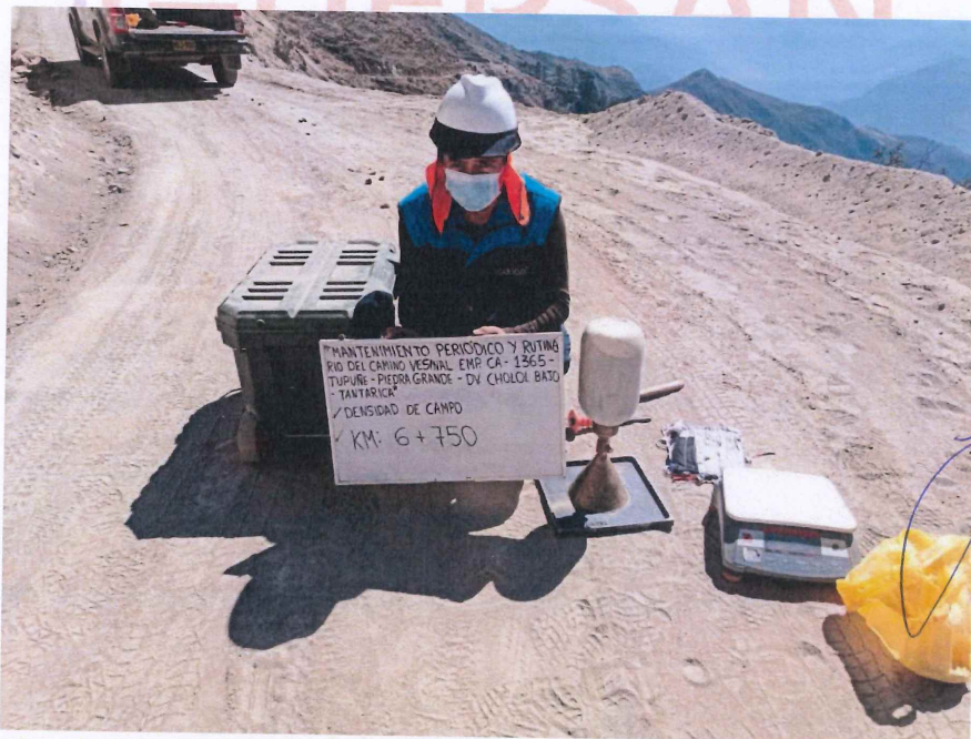
FIGURA N° 28. Ensayo de Densidad de Suelo en Campo. Progresiva 06 + 750 (Método del cono de arena).
